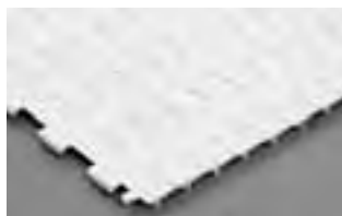
SERIE 1650 MINIMUM HINGE FLAT TOP • Accionamiento central • Bisagra abierta • Paso de 1,00 pulg. (25,4 mm) • Borde liso
