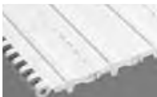
SERIE 800 MINI RIB • Accionamiento central • Bisagra abierta • Paso de 2,00 pulg. (50,8 mm)
