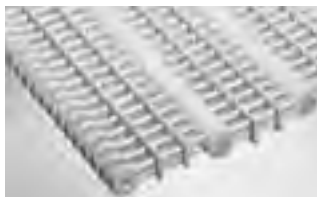
SERIE 200 • Accionamiento por bisagra • Bisagra cerrada • Paso de 2,00 pulg. (50,8 mm) • Sin borde al ras
