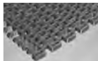
SERIE 2600 (2,5) • Accionamiento por bisagra • Bisagra abierta • Flexión lateral • Paso de 2,00 pulg. (50,8 mm)
