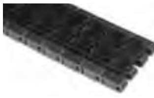
SERIE 1400 FLAT FRICTION DE 3,25 PULG. CON LENGÜETAS • Accionamiento central/por bisagra • Bisagra cerrada • Paso de 1,00 pulg. (25,4 mm) • Ancho disponible: 6,0 mm (152 mm).
