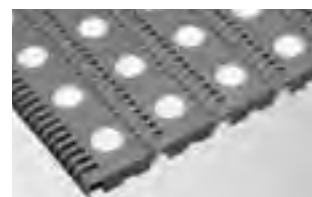
SERIE 400 BALL • Accionamiento central • Bisagra cerrada • Paso de 2,00 pulg. (50,8 mm)
