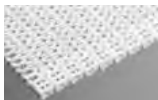
SERIE 1100 NUB TOP • Accionamiento por bisagra • Bisagra abierta • Paso de 0,60 pulg. (15,2 mm)
