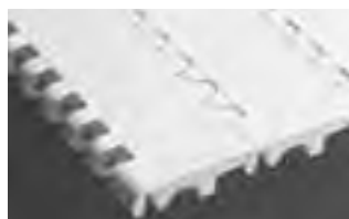
SERIE 1800 • Accionamiento central • Bisagra abierta • Paso de 2,50 pulg. (63,5 mm)
