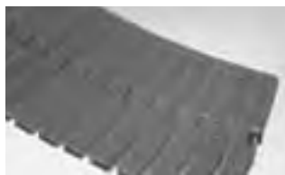
SERIE 4091 SIDEFLEXING FLAT TOP • Accionamiento por bisagra • Bisagra cerrada • Paso de 1,00 pulg. (25,4 mm) • Anchos disponibles: 4,5 pulg. (114 mm), 7,5 pulg. (191 mm)
