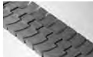
SERIE 4014 FLAT TOP • Accionamiento por bisagra • Bisagra cerrada • Flexión lateral • Paso de 1,00 pulg. (25,4 mm) • Ancho disponible: 83,8 mm (para recorrido paralelo a 85 mm)
