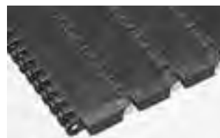
SERIE 900 • Accionamiento central • Bisagra cerrada • Paso de 1,07 pulg. (27,2 mm)
