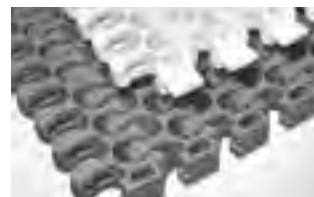
SERIE 2200 • Accionamiento por bisagra • Bisagra abierta • Flexión lateral • Paso de 1,50 pulg. (38,1 mm)
