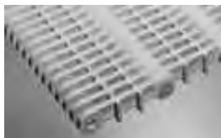
SERIE 200 • Accionamiento por bisagra • Bisagra cerrada • Paso de 2,00 pulg. (50,8 mm) • Bordes irregulares
