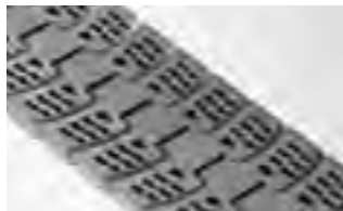
SERIE 4009 FLUSH GRID • Accionamiento por bisagra • Bisagra cerrada • Flexión lateral • Paso de 1,00 pulg. (25,4 mm) • Ancho disponible: 83,8 mm (para recorrido paralelo a 85 mm)
