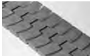
SERIE 4009 FLAT TOP • Accionamiento por bisagra • Bisagra cerrada • Flexión lateral • Paso de 1,00 pulg. (25,4 mm) • Ancho disponible: 83,8 mm (para recorrido paralelo a 85 mm)
