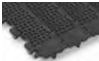
SERIE 850 MINIMUM HINGE NUB TOP • Accionamiento central • Bisagra abierta • Paso de 2,00 pulg. (50,8 mm) • Borde liso
