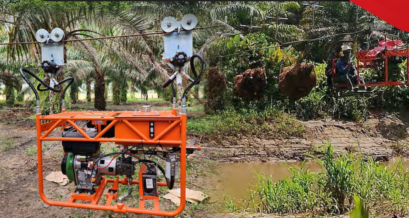
Nuestro tractor aéreo es una tecnología utilizada en el sector agroindustrial para transportar productos, como palma, banano, flores e incluso materiales agrícolas, de un lugar a otro utilizando un sistema de cables suspendidos e impulsado por un motor Diesel de (10 HP @ 3600rpm), que permite el movimiento de una bomba y dos motores hidráulicos de origen italiano.
